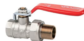
Kurek kulowy pełnoprzelotowy z dławikiem z półsrubunkiem z dźwignią stalową, wersja wkrętno-nakrętna
