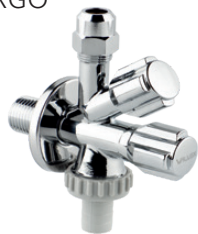
Kod Wymiary P nom. / max temp. 1482100 1/2"-3/8"-3/4" PN 10 / 80°C
