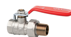
Kurek kulowy pełnoprzelotowy z dławikiem z półśrubunkiem z dźwignią stalową, wersja wkrętno-nakrętna
